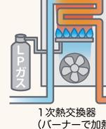
潜熱回収型給湯器
