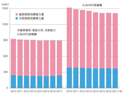
※冷暖房兼用・壁掛け形・冷房能力2.8kWと4.0kWの寸法規定クラス 省エネ性能カタログ夏版・冬版の単純平均値
