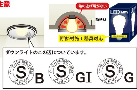
断熱材施工器具対応かどうかは、ダウンライトなどの枠や反射板、パッケージに表示されています。
