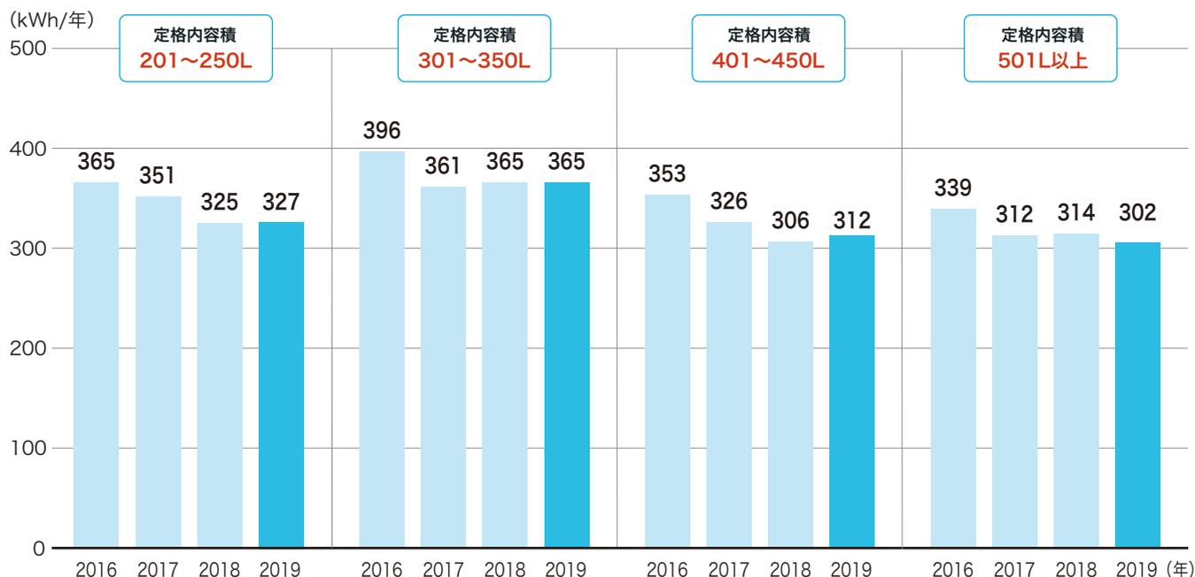
年間消費電力量は、日本工業規格JIS C 9801:2015「家庭用電気冷蔵庫及び電気冷凍庫の特性及び試験方法」に基づき測定された年間消費電力量(kWh/年)を整数で表示しています。(定格周波数が50ヘルツ・60ヘルツ共用のものは、それぞれの周波数で測定した数値のうち大きいものとします。また、切替室があるものは、それぞれの状態で測定した数値のうち大きいものとします。)
