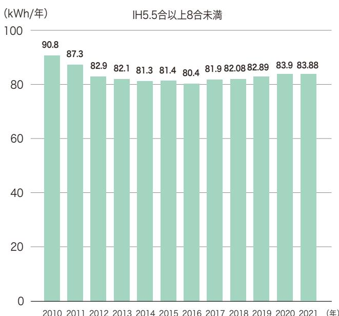
ジャー炊飯器の年間消費電力量は、炊飯時、保温時、タイマー予約時及び待機時それぞれの消費電力量を測定し、家庭における最大炊飯容量ごとの使用実態をもとに算出して合計した値を、有効数字3桁以上で表示しています。
