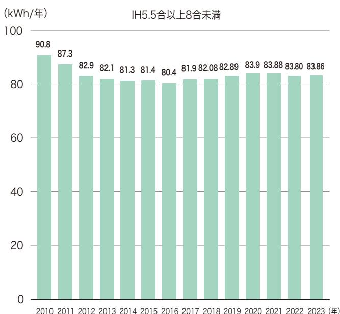
ジャー炊飯器の年間消費電力量は、炊飯時、保温時、タイマー予約時及び待機時それぞれの消費電力量を測定し、家庭における最大炊飯容量ごとの使用実態をもとに算出して合計した値を、有効数字3桁以上で表示しています。
