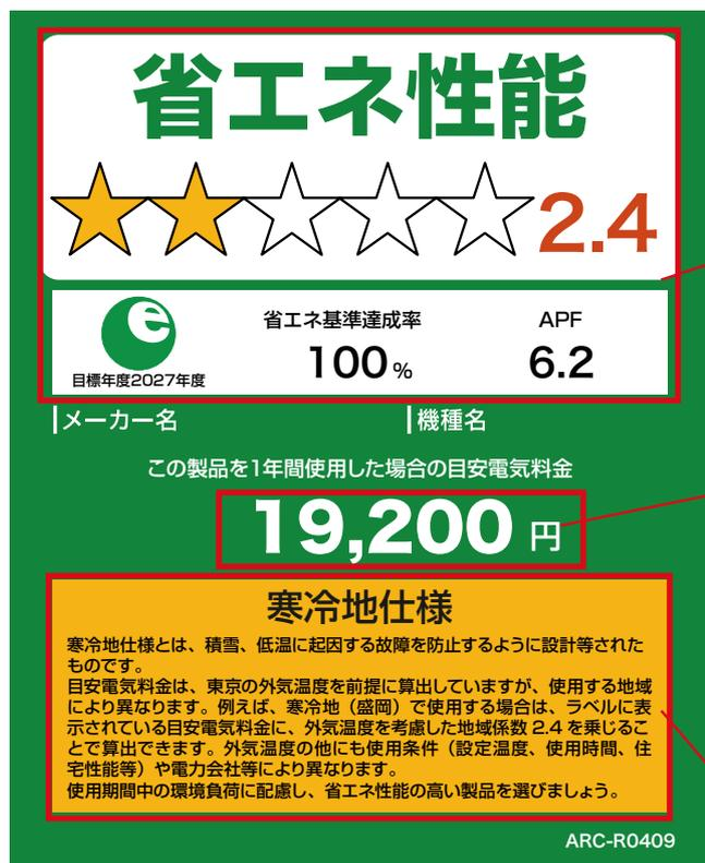
寒冷地仕様のエアコンは、寒冷地での使用を想定し、積雪、低温に起因する故障を防止するように設計等されたものです。寒冷地仕様以外のエアコンとは省エネ性能の基準値が異なります。
